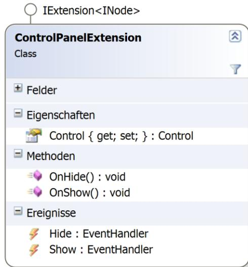
Diagramm 36 DynamicNode.Ext.Visual.ControlPanelExtension
